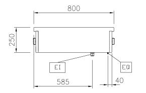
Electrical inlet (power) Equipotential screw
